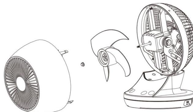
3. Očistite lopatky ventilátora a jeho vnútornú časť mäkkou suchou handričkou. Pri zostavovaní ventilátora postupujte opačne. Uistite sa, že je zaistovací uzáver pevne dotiahnutý.
