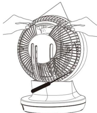
2. Stlačte štyri zámky a odstráňte predný kryt. V prednej časti vrtule ventilátora sa nachádza matica vrtule – ak chcete demontovať vrtuľu ventilátora, maticu odskrutkujte.
