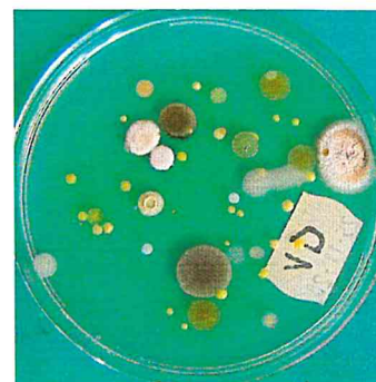
Po jednání Nárůst bakterií a plísní na agaru podle ČSN EN 4833
